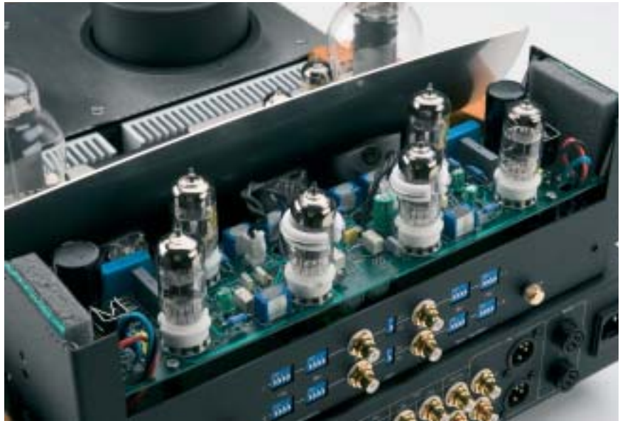
L'ingresso fono è collocato su una basetta sospesa, ovviamente allo scopo di minimizzare la trasmissione delle vibrazioni. L'anello semichiuso che circonda il triodo d'ingresso, di gran lunga il più esposto alla microfonicità, ha scopo analogo rispetto alla tendenza risonante del vetro dei tubi.
