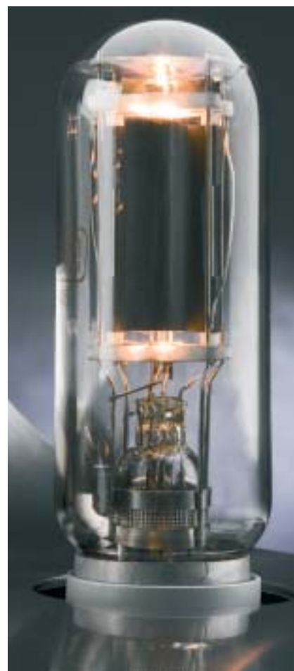
Il triodo a riscaldamento diretto 845, che potremmo vedere come "fratello maggiore" del più famoso triodo a riscaldamento diretto 300B usato nel pre. Il modello 845 è stato reso famoso proprio dalle realizzazioni Unison, tra le quali il modello Absolute 845.
