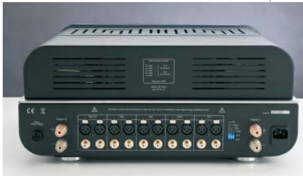
Gli ingressi bilanciati e sbilanciati sono connessi in parallelo sul canale caldo e i microinterruttori posti sul lato sinistro attivano dei microrelè che cortocircuitano i terminali freddi degli ingressi bilanciati con lo zero V d'ingresso (massa elettrica). Sul lato sinistro è visibile il connettore circolare per il collegamento dell'alimentazione dello stadio fono.
