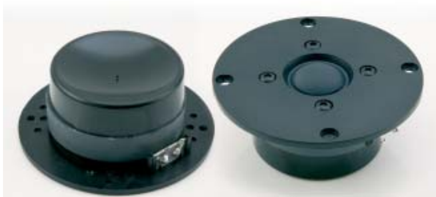
Il tweeter a cupola morbida dispone di una camera di decompressione posteriore, atta a regolarizzarne le risonanze.
