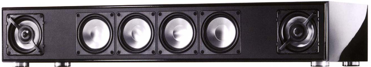
In de Canton DM90 zitten vier 11cm 'woofers' met een diepte van 70mm, twee coaxiale 'drivers' voor 'mid-den/hoog' met een diepte van 74mm en een uiterst compacte digitale versterker.
